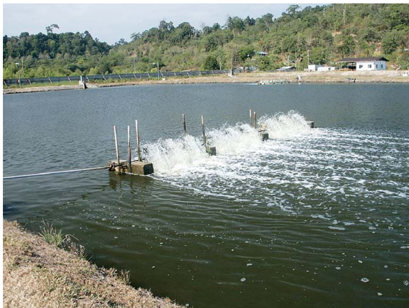
利用电动打水车增加水中溶氧已普遍应用在世界各国的池塘养殖业上。
